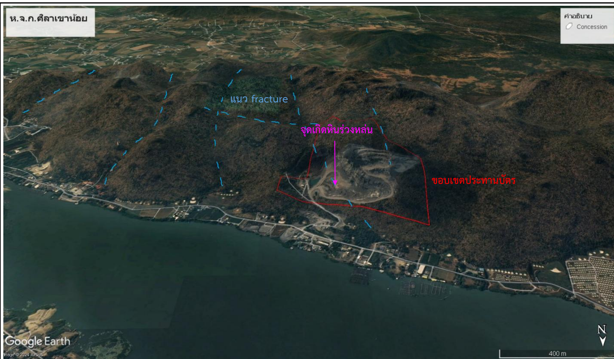
รูปที่ 1.4-2 แนว Fracture บริเวณพื้นที่โครงการและบริเวณใกล้เคียงและจุดเกิดหินร่วง
